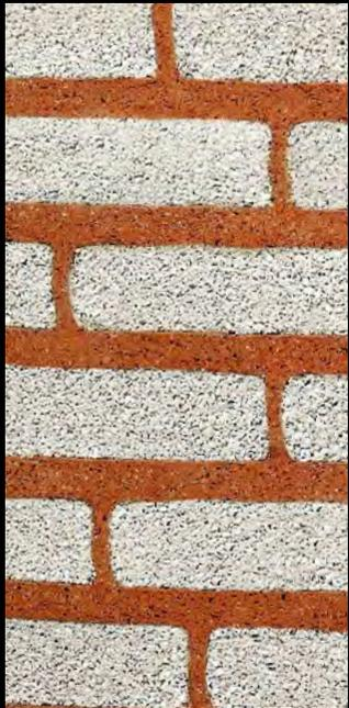
Ziegelmauerwerk mit Perlitefüllung T8, 42,5 cm
