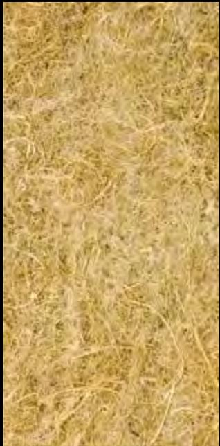
Hanf mit Stützfaser auf Polyesterbasis und alternativ mit Stützfaser auf pflanzlicher Basis (kompostierbar)
