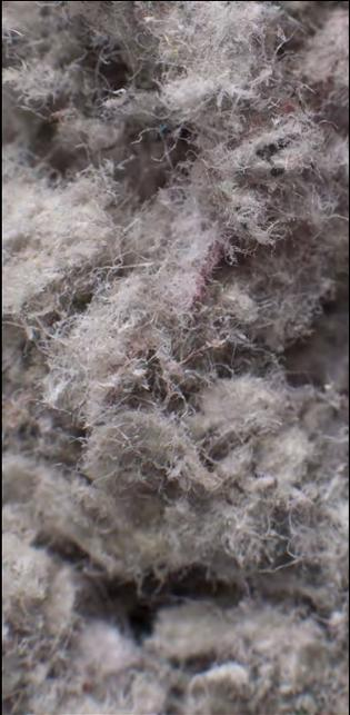
Einblasdämmung aus Zellulosefasern
