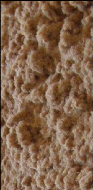
Einblasdämmung aus Holzfasern
