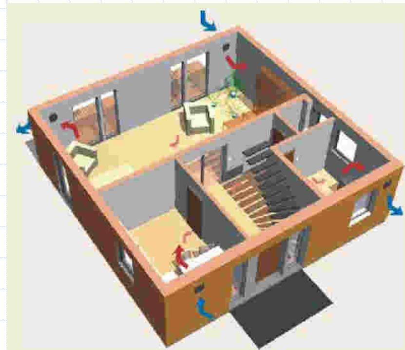
dezentrale Lüftungsanlage (Sanierung)
