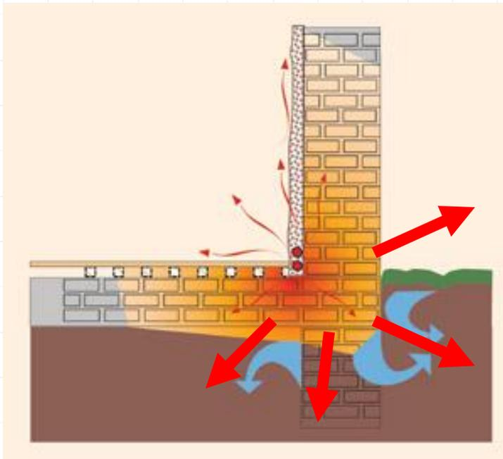
Sanierung mittels Sockelheizung ohne entsprechende Dämmung führt zu hohen Energieverlusten.
