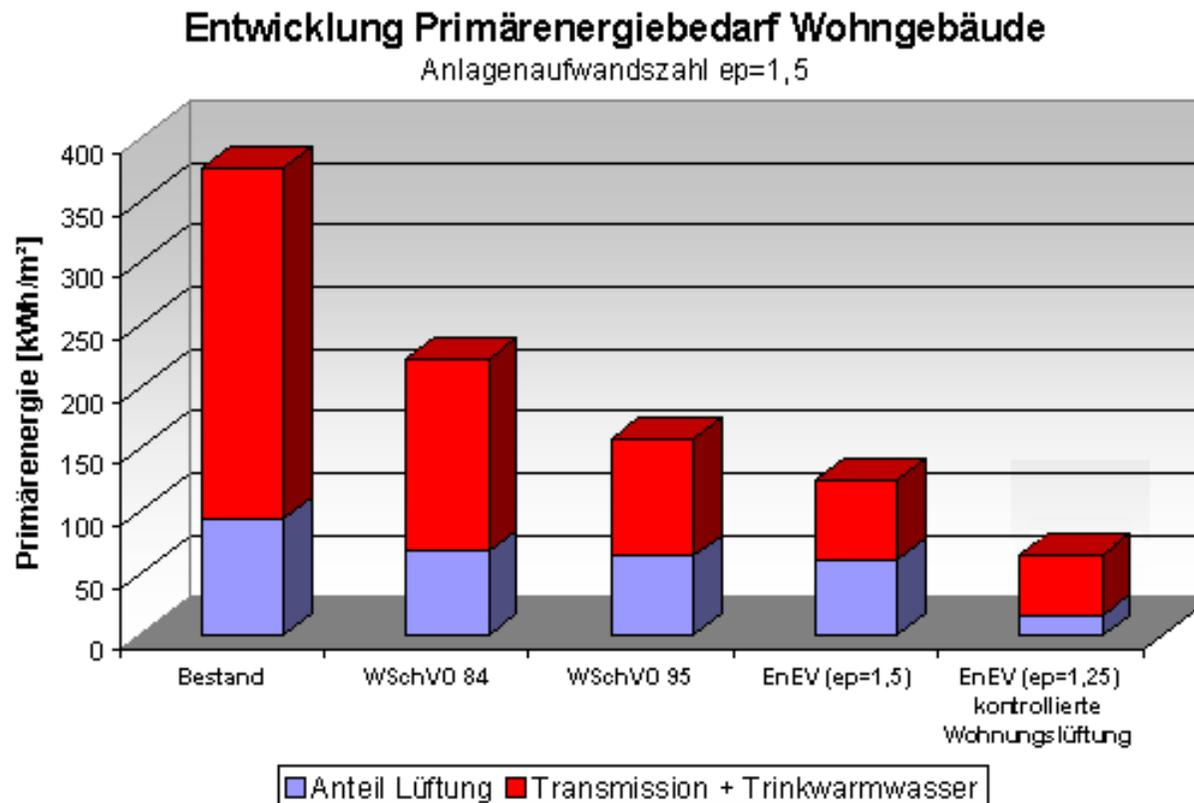
Während der Transmissionswärmeanteil mit zunehmender Dämmung fällt, bleibt der Lüftungswärmebedarf konstant. Erst mit kontrollierter Wohnungslüftung kann der Wärmebedarf weiter gesenkt werden.
