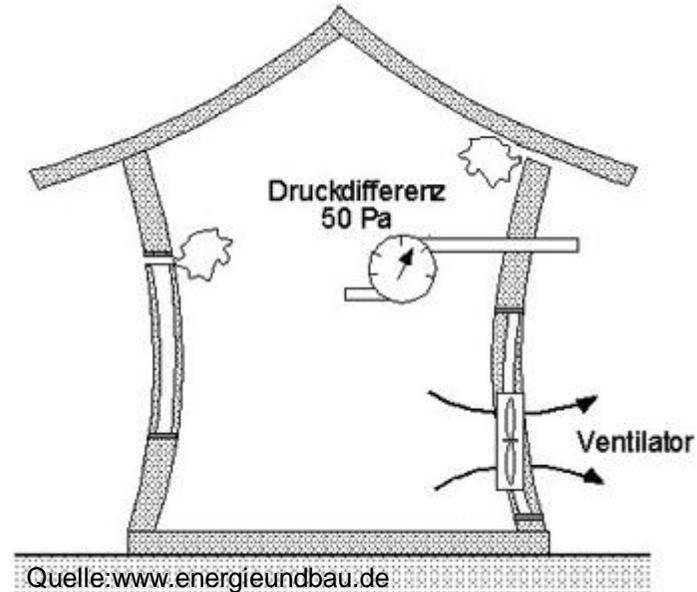
**Luftwechselrate Passivhaus  $\leq 0,6 \text{ h}^{-1}$**
