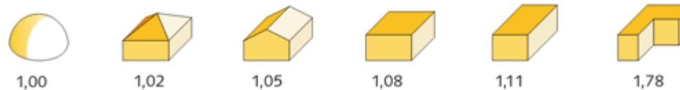
A/V-Verhältnis bei der Zusammensetzung eines Körpers von  $10\text{m} \times 20\text{m} \times 5\text{m}$
